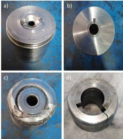
圖 2 扣件鍛造成形模具破裂紋方向型態 (a) 沖孔徑向破裂 (b) 模孔軸向破裂 (c) 外殼徑向破裂 (d) 應力環及模孔軸向破裂
