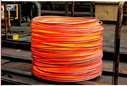
Wire rod \Phi \approx 5\text{mm} \sim 42\text{mm} (alloy or non-alloy)
